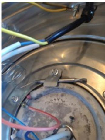
Dévisser le support de la sonde de température (tube au bout du serpentin)
